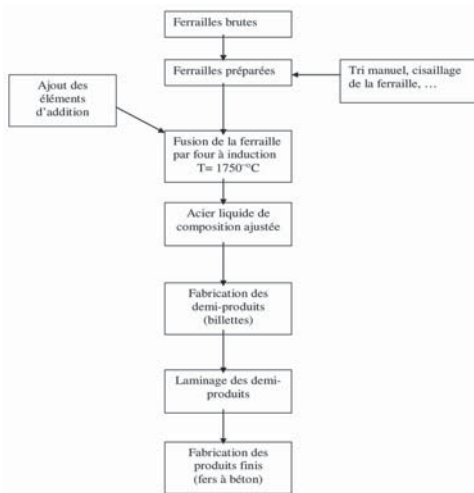
Figure 3 : Processus de recyclage de l'acier utilisé dans l'une des plus grandes entreprises de recyclage camerounaise
