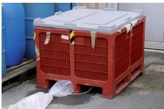
Figure 1 - Bac de décantation fermé
