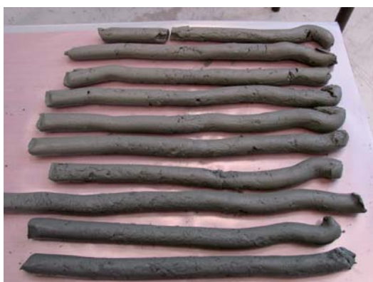
Figure 3 - Boudins de sédiments cimentés
