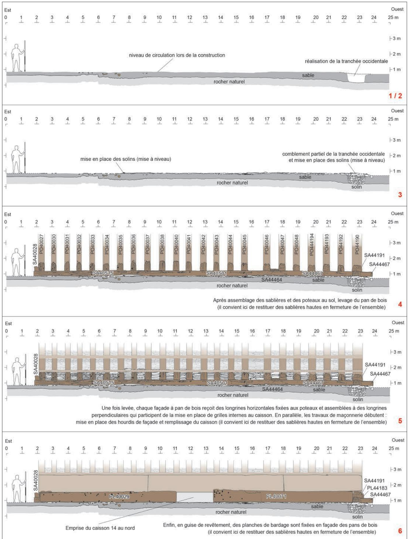
Fig. 12 – Hypothèse de restitution des étapes de la construction de la façade septentrionale du caisson n° 9 (DAO: J. Mouchard).
