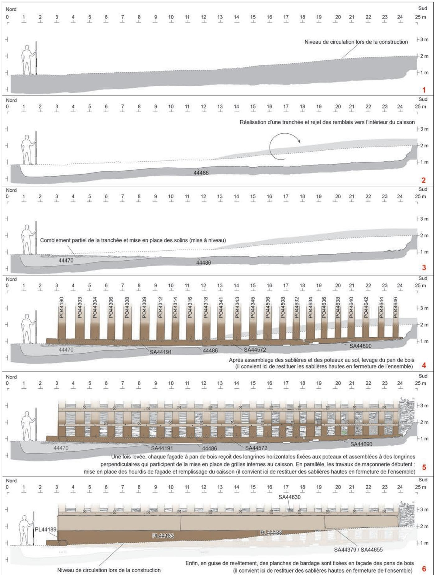
Fig. 13 – Hypothèse de restitution des étapes de la construction de la façade occidentale du caisson n° 9 (DAO: M. Yacger).
