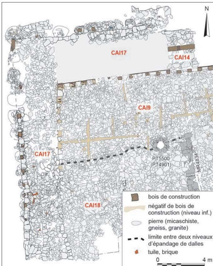
Fig. 22 – Plan des caissons n°s 14 et 17, construits au 1<sup>er</sup> s.apr. J.-C. pour agrandir et conforter le premier caisson n° 9 (DAO: J. Mouchard, M. Yacger).
