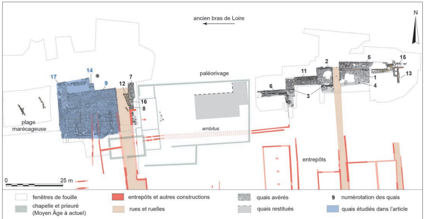
Fig. 1 – Plan des aménagements de berge monumentaux construits entre la fin du 1 er s. apr. J.-C. et le milieu du 11 e s. apr. J.-C. dans le quartier de Saint-Lupien à Rezé (Loire-Atlantique) et localisation du caisson n° 9 (DAO: J. Mouchard, université de Nantes).
