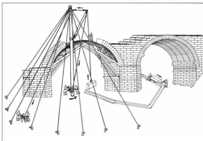
Fig. 27 – Restitution de la bigue édifée au devant d’une pile du pont du Gard, ouvrage d’art de l’aqueduc de Nîmes (Gard) (Bessac 2003, fig. 19).
