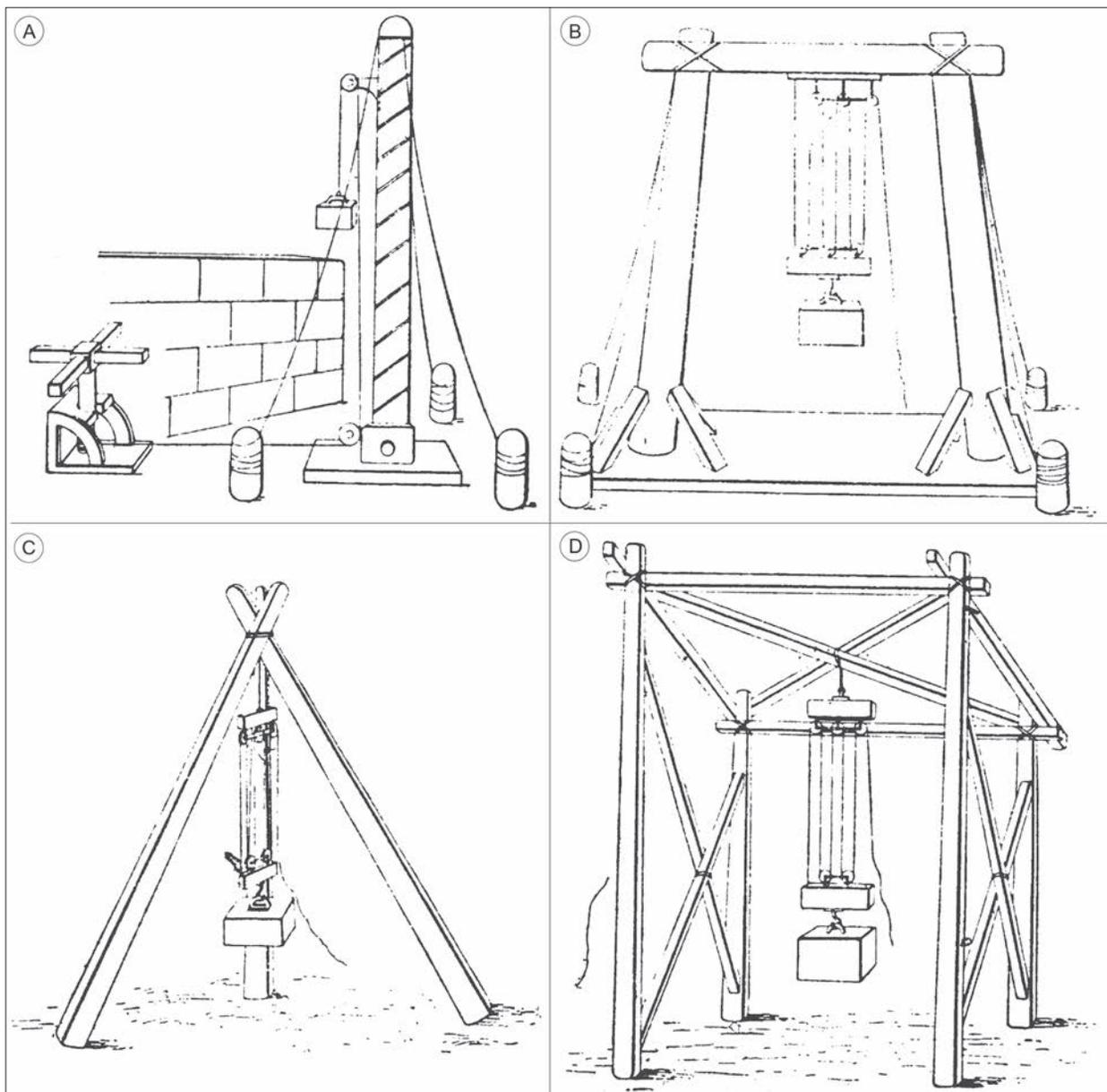
Fig. 26 – Interprétation du texte de Héron d’Alexandrie par Bernard Carra de Vaux: A, grue à un seul montant; B, à deux montants; C, à trois montants; D, à quatre montants (Carra de Vaux 1893, p. 485-489, fig. 49-52).
