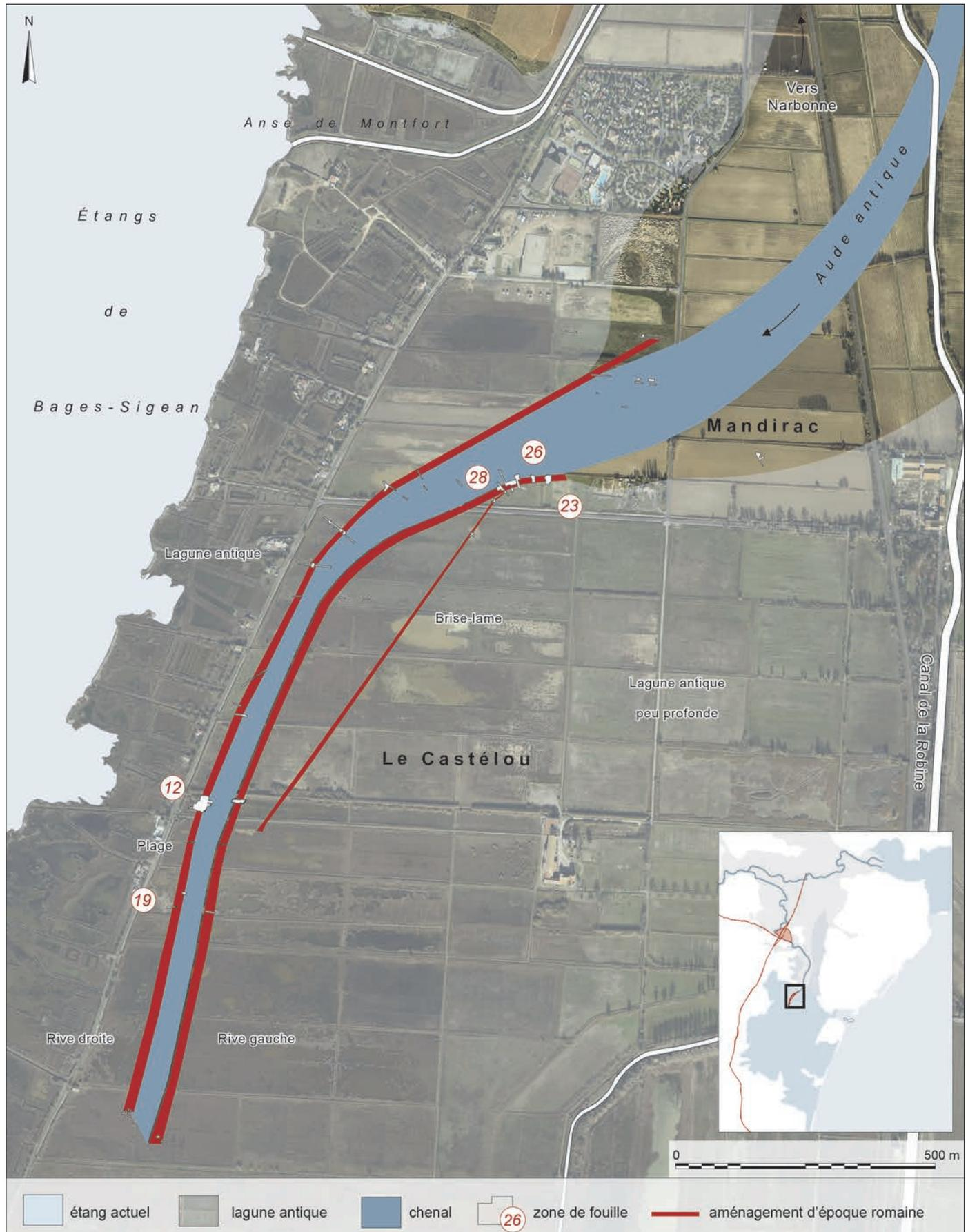
**Fig. 2** – L’embouchure canalisée du Castérou (aval) et de Mandirac (amont) au sud de Narbonne. Ces jetées encadraient le passage du fleuve au moment où il arrivait dans une lagune peu profonde. Elles ont été explorées sur 1,70 km de long et étaient maintenues par des aménagements en bois (cliché : Aérodata ; DAO : J. Caverro).
