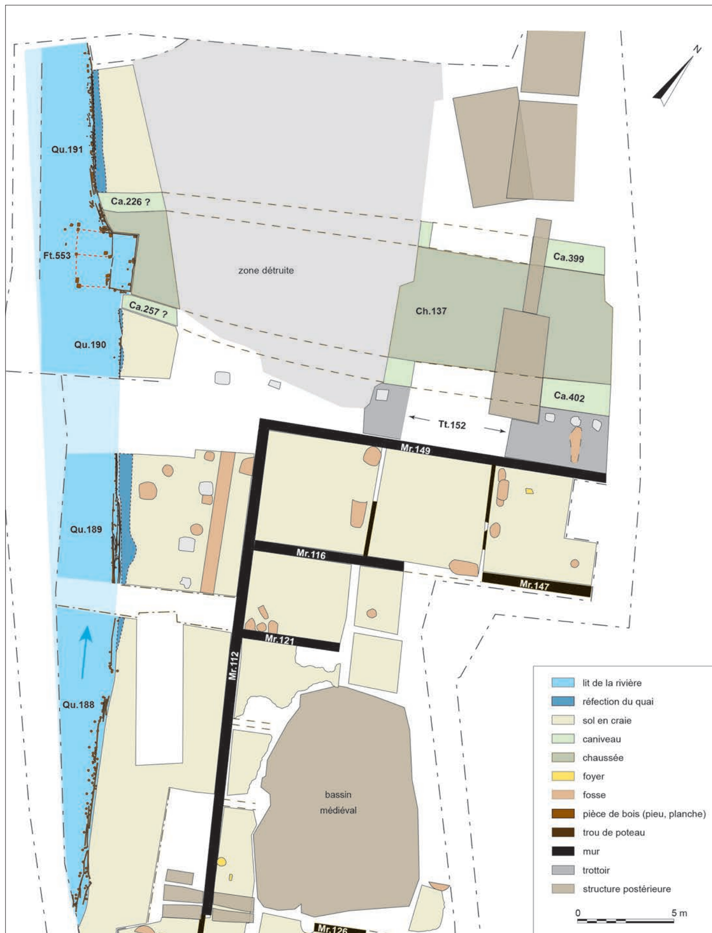
Fig. 10 – Plan des tronçons des quais Qu.189, 190 et 191 et de l'aménagement en bois Ft.553 (DAO : F. Moiret).
