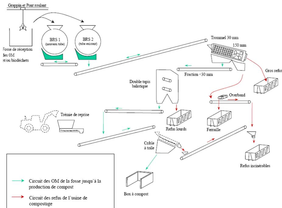
**Figure 1 : Synoptique du fonctionnement de l'usine de Launay Lantic**
