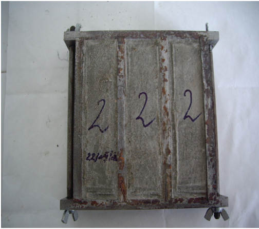
Photo 1 : Eprouvettes de mortier normalisé (4*4*16)
