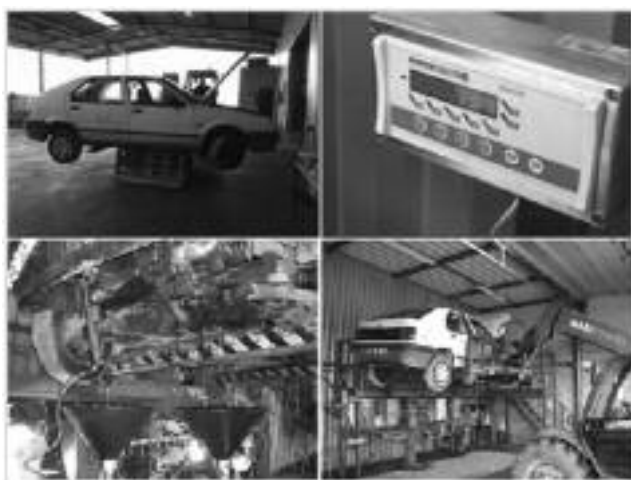
Figure 9 Opération de pesée et de dépollution
