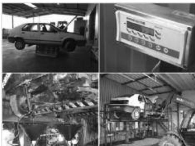
L'interface de collecte, qui assure le passage de la canalisation ou du réservoir, peut-être une simple canule souple (liquide lave-glace et liquide de frein), un vase pour les écoulements gravitaires (huiles moteurs) ou encore un système de perforation mécanique (liquide de refroidissement) ou électrique (carburants).
