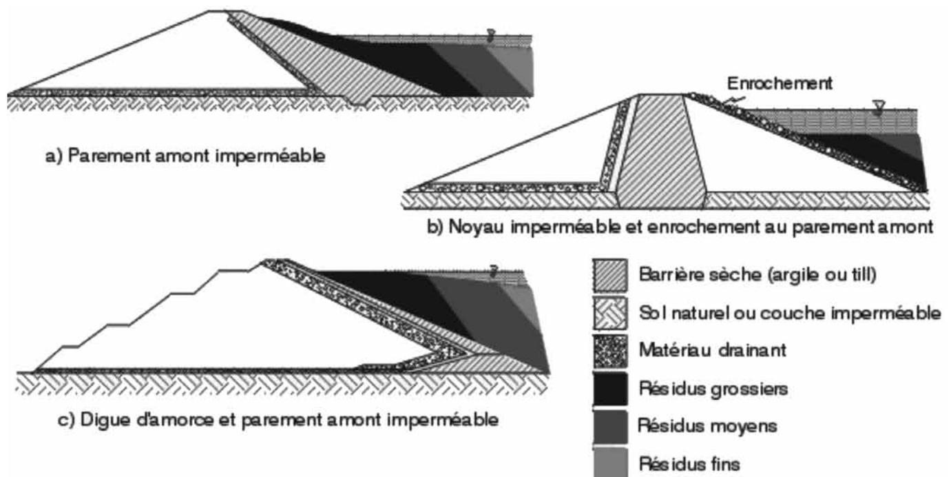
Figure 2. Méthodes de construction des digues formées de rejets miniers (tiré de Aubertin et al., 2002a).
