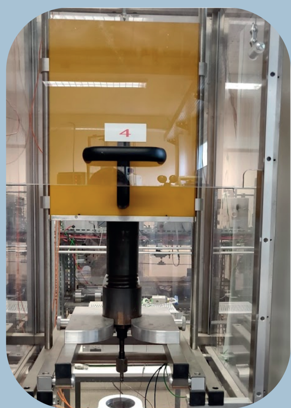
Figure 3 : Dispositif de maturation artificielle. Autoclave surmonté d'un four (jaune) relié à une pompe.
