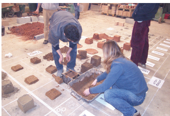
Fig. 3 : Exercice « Composition de la Terre ». Fabrication d'échantillons à l'intérieur même d'une matrice géante, dans des cellules correspondantes à des paramètres identifiés de la terre.
