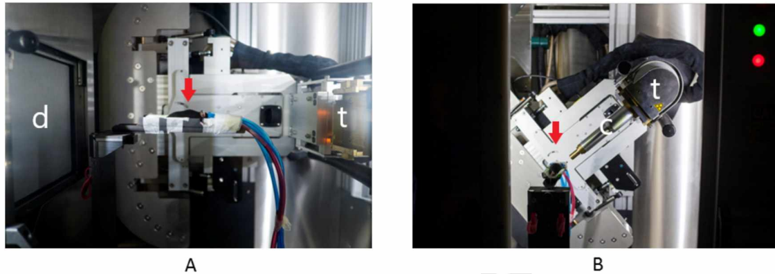
Fig. 6. Le SARRP ( Small Animal Radiation Research Platform [Xstrahl]). A. En configuration imagerie CBCT ( Cone Beam Computed Tomography ), avec le tube à RX (t) à droite et le détecteur plan (d) à gauche. Le lit portant la souris (flèche) tourne à 360° pour acquérir une image en 3 dimensions. B. En configuration irradiation avec la souris sur le lit d'irradiation (flèche) et le collimateur (c) fixé à la sortie du tube (t).
