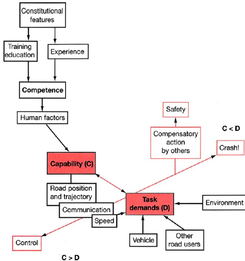
**Figure 8. :** Modèle d'interface Tâche - Capacité [FUL00]
