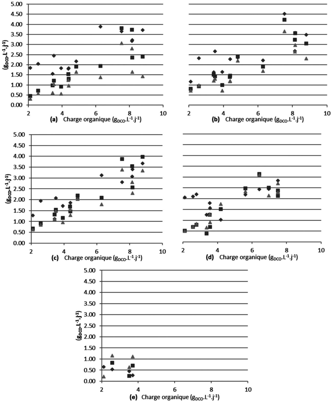
Figure 3. Vitesse de production de méthane (◆), d'élimination de la DCO (■) et de l'hydrolyse (▲), exprimées en  $g_{\text{DCO}} \cdot L^{-1} \cdot j^{-1}$ , pour 28 (a), 37 (b), 49 (c), 55 (d) et 60°C (e).
