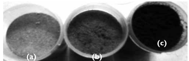
Figure 6. Examen visuel du sable traité après séchage (a): sable propre, (b): sable lavé, (c) sable contaminé
