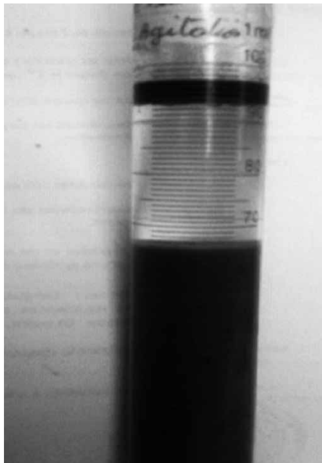
Figure 3. Aspect d'un échantillon de sable fin après lavage.
