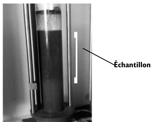
Figure 5. Échantillon lavé en colonne par barbotage d'air
