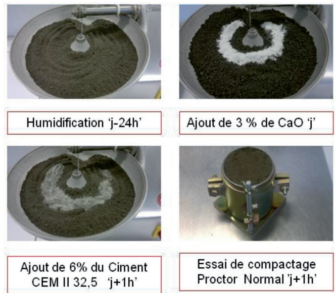
Figure 5. Différentes étapes de préparation des sédiments traités pour réaliser l'essai Proctor normal.
