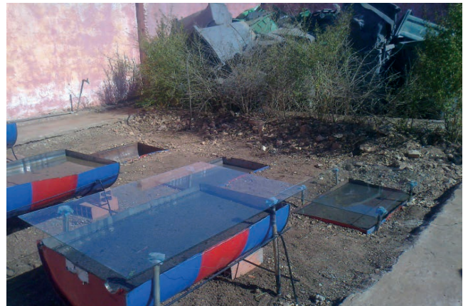
Figure 2 : Bacs d'évaporation enterrés ou hors sol, avec et sans vitre horizontale
