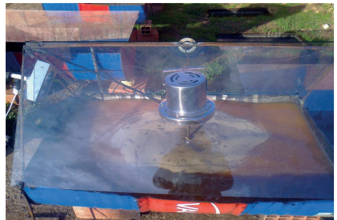
Figure 3 : Bac expérimental d'évaporation forcée couvert d'une vitre inclinée et équipé d'un dispositif d'agitation et ventilation
