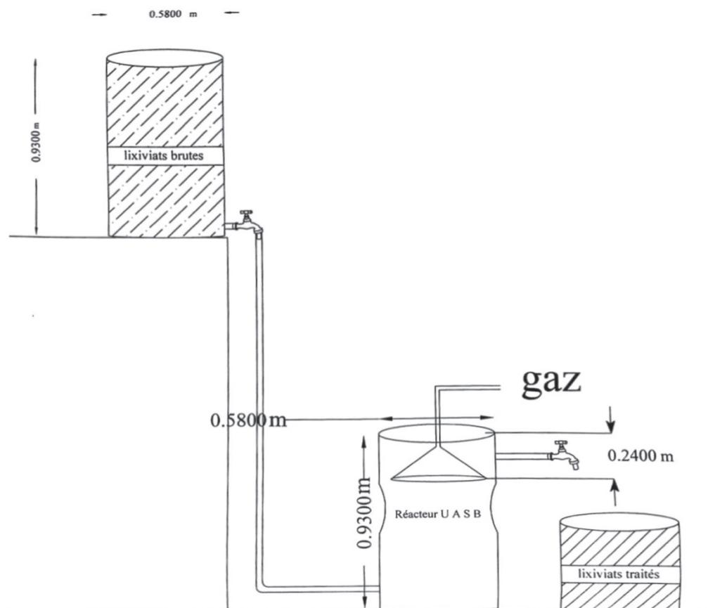
Figure 1 : Schéma du réacteur UASB expérimenté
