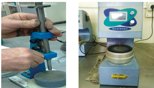
Figure 3. Vue de l'appareil de Vicat et des essais réalisés
