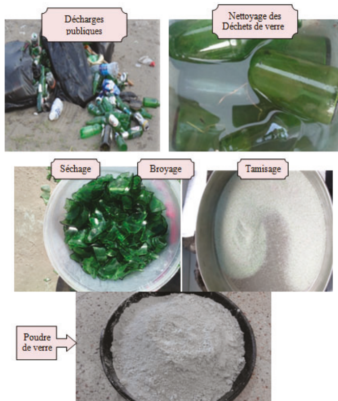
Figure 1. Transformation des déchets de verre en poudre de verre
