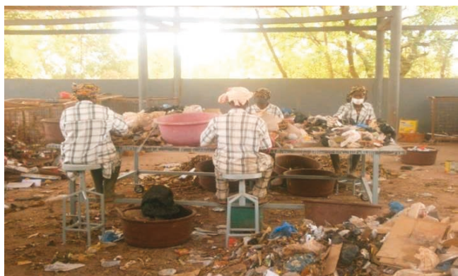
Photo 4. Tamisage des déchets pour séparer les fines
