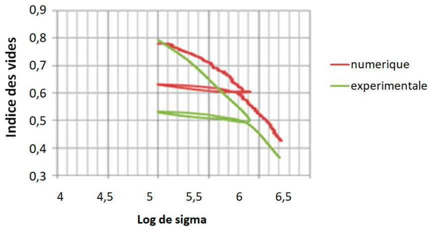
**Figure 3.a Déformation dans des conditions œdométriques pour le sol modèle traité (indice des vides en fonction de log de sigma).**
