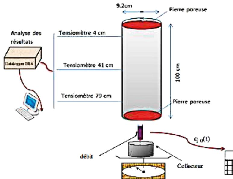
Figure 3. Dispositif expérimentale de l'essai en colonne
