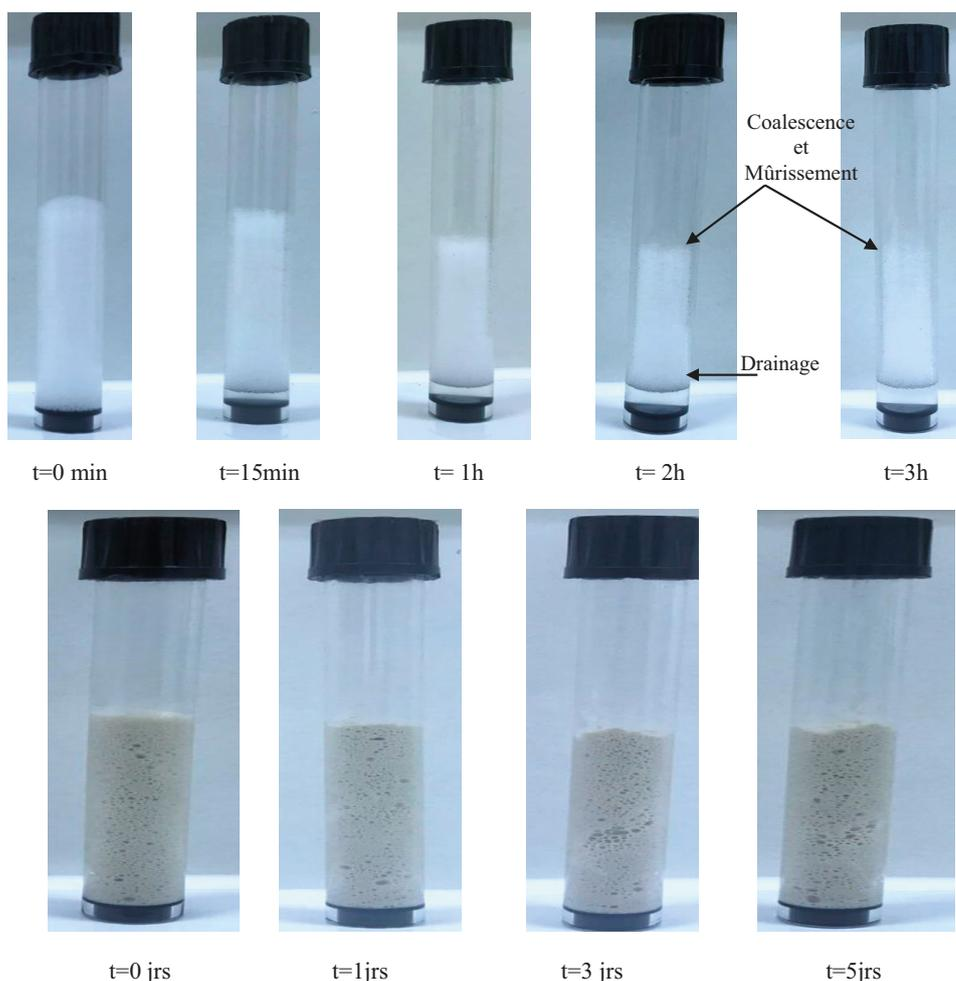
**Figure 6. Illustration de l'évolution de la structure de la mousse seul et dans le sol au court du temps : a. Evolution à court terme de la structure de la mousse liquide. b. Evolution à long terme de la structure du sol traité**
