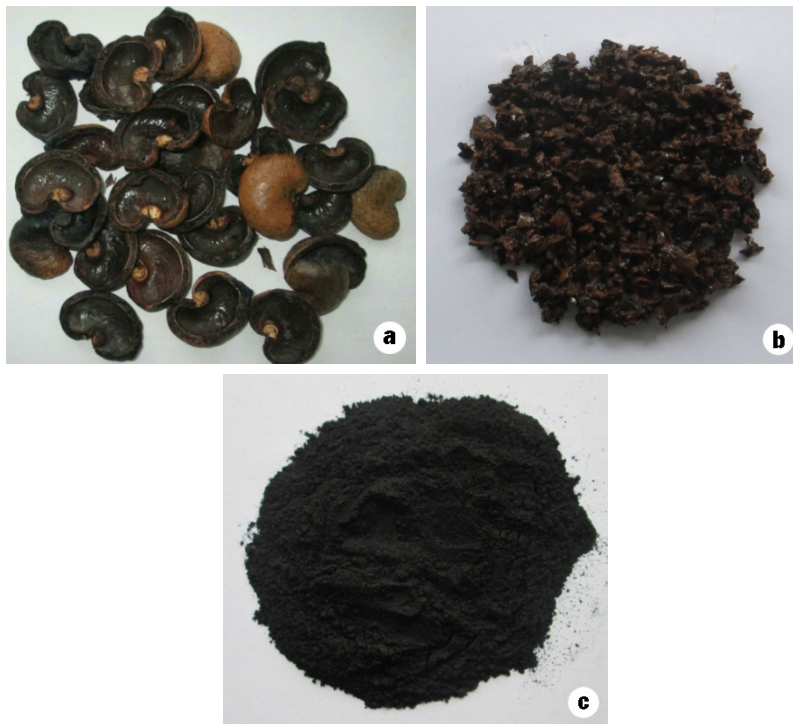
Figure 1. Photos de Coques de noix d'anacarde CNA brutes (1a, fraction : 2,5-3,5cm.) et broyées (1b : fraction 3-6 mm) ainsi que du charbon actif préparé par traitement de cette ressource (1c)
