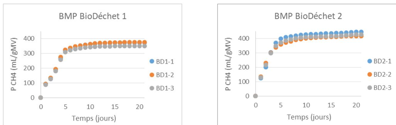
**Figure 3. Production de méthane (P CH<sub>4</sub>) des deux lots de biodéchets (BioDéchets 1 en haut, BioDéchets 2 en bas) utilisés comme matériau facilement biodégradable de référence**
