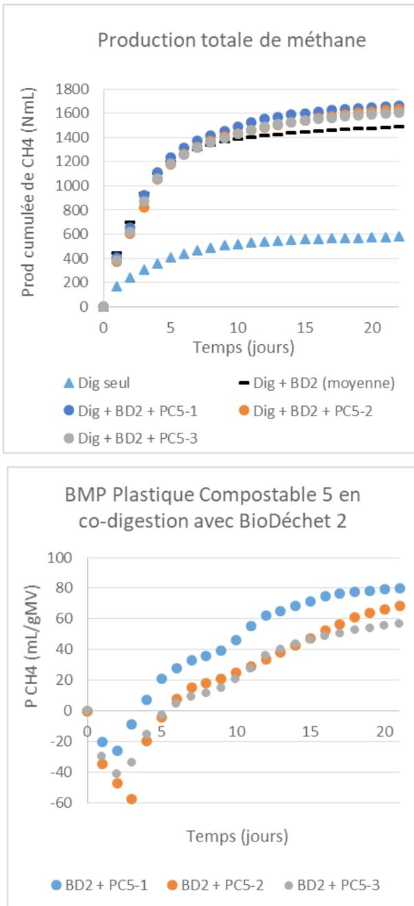
**Figure 5. Exemple de production totale de méthane des essais sur le Plastique Compostable 5 (PC5) en co-digestion avec le Biodéchets 2 (BD2) comprenant l'inoculum (noté Dig, graphique du haut), et de calcul du BMP après soustraction de la contribution de l'inoculum (graphique du bas).**
