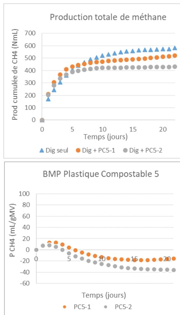
**Figure 4. Exemple de productions totales de méthane des essais sur le Plastique Compostable 5 (PC5) comprenant l'inoculum (noté Dig, graphique du haut), et de calcul du BMP après soustraction de la contribution de l'inoculum (graphique du bas).**
