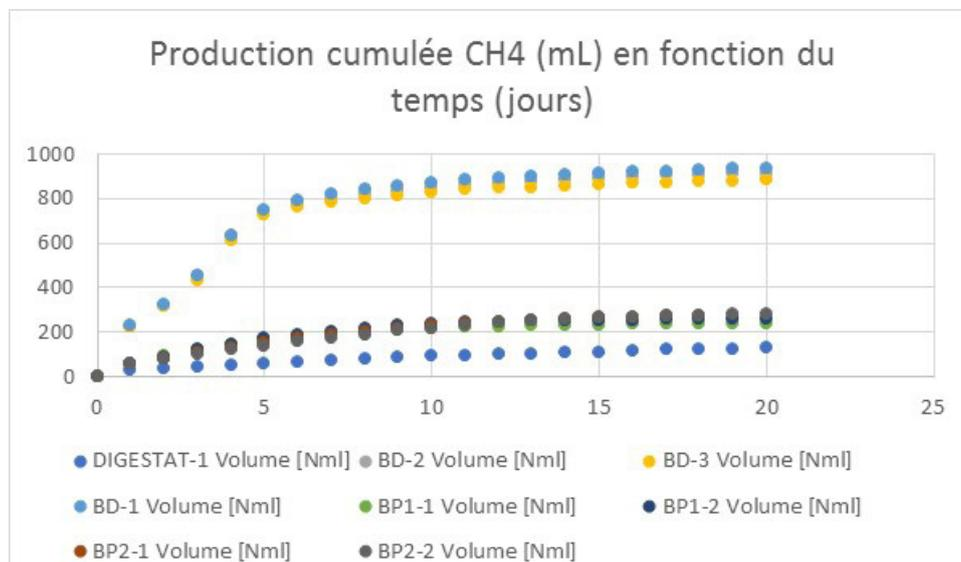
**Figure 2. Analyse en continu de la production de CH<sub>4</sub> par le système AMPTSII automatisé permettant de suivre la biodégradation anaérobie des plastiques compostables, des sacs en papier et des biodéchets**
