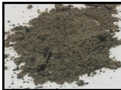
Figure 4. Image des cendres expérimentales de coques d'anacarde
