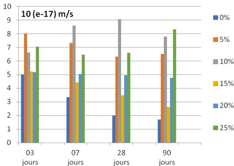
Figure 7. Diagramme exprimant la conductivité hydraulique du béton
