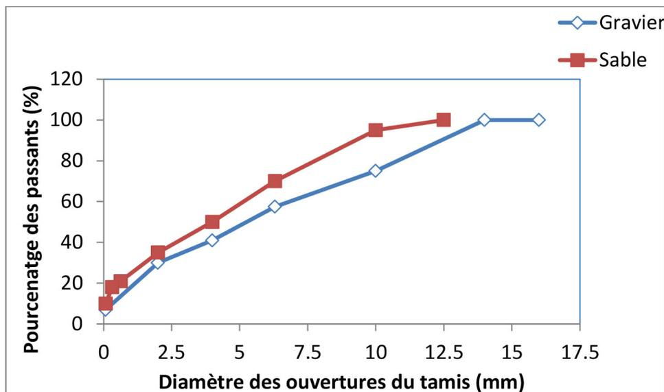
Figure 2. Analyse granulométrique du sable et du gravier utilisé
