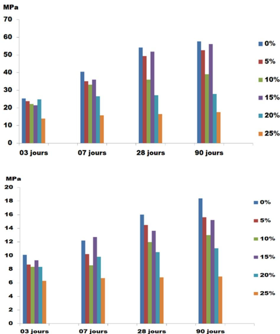
**Figure 6. Résistances à la compression (en haut) et à la traction (en bas) mesurées à différents temps de prises sur les bétons réalisés avec des taux de cendres croissants en substitution au ciment.**
