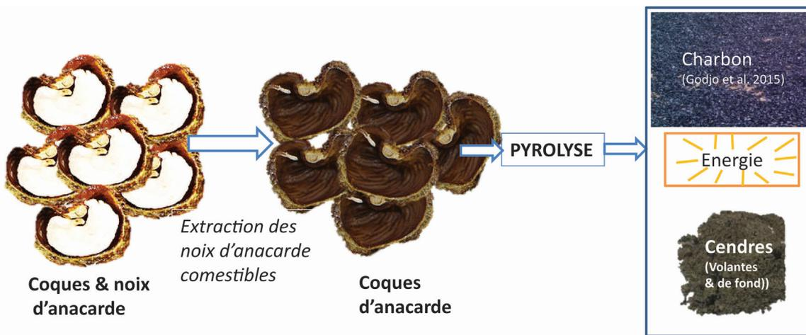
Figure 3. Représentation du traitement thermochimique des coques d'anacarde
