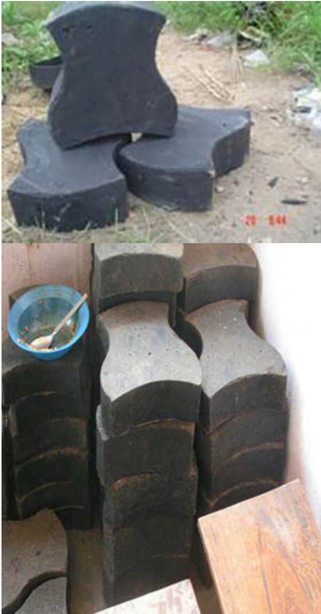
Photo 1. Photographies de pavés produits à partir de plastiques recyclés Source : RECOVAD, 2013
