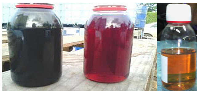
Figure 1. Aspect de l'huile de vidange avant traitement (à gauche), après traitement aux sels fondus et distillation sous pression réduite (centre) et à l'issue du traitement complet (à droite)
