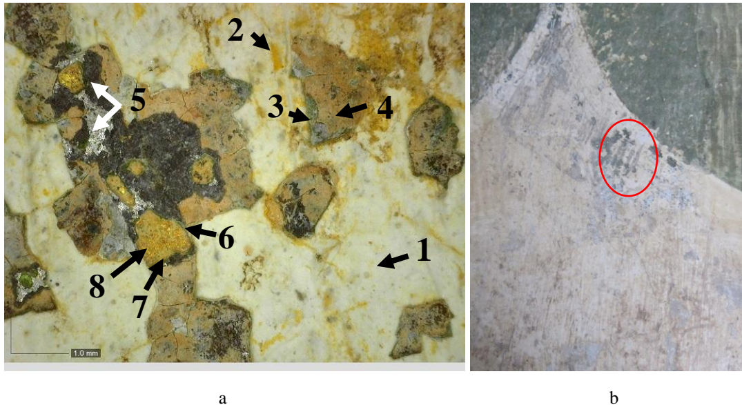
Figure 5 : (a) résidus des décors métalliques sur un chardon : enduit (1), préparation à l'ocre (2), fond vert (3), mordant de l'étain (4), étain métallique et oxydé (5), résinate de cuivre (6), mordant de l'or (7) et feuille d'or (8) ; (b) traits (dans cercle rouge) riches en Ag pouvant faire partie du décor d'origine.
