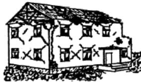
**D4 : Dommages très importants :** Ouverture partielle de murs (défaillance), nombreuses et larges fissurations dans la plupart des murs
