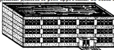
**D1 : dommages négligeables à légers** : fissures millimétriques dans le plâtre ou revêtement des poteaux ou poutres ou sur les murs à la base. Quelques fissures millimétriques dans les cloisons et les remplissages en maçonnerie (entre les poteaux porteurs).
