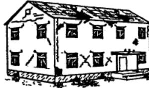
**D3 : dommages sensibles à importants :** fissures importantes dans la plupart des murs, chutes tuiles et fracture de cheminée à la base
