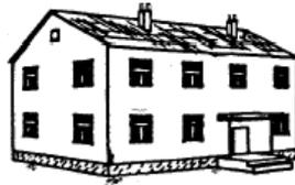
**D1 : dommages négligeables à légers :** fissures millimétriques dans très peu de murs, chute de petits débris de plâtre ou de petits morceaux de crépis
