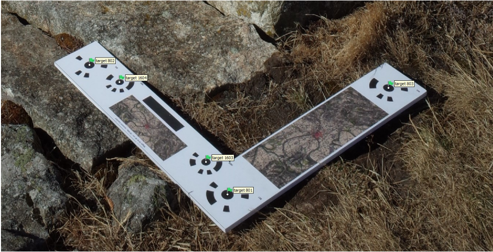
Figure 9 : Détection des règles photogrammétriques.
