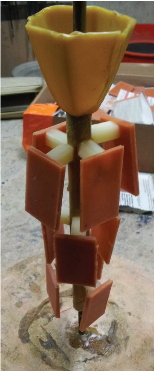
Fig. 5. Modèle en cire d'une grappe de coulée avec les dix plaquettes (© J. Devogelaere).
