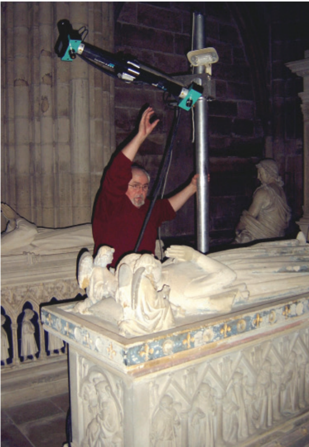
Fig. 2. Numérisation 3D du gisant de Philippe-Dagobert, par lumière structurée ( P. Callet).
