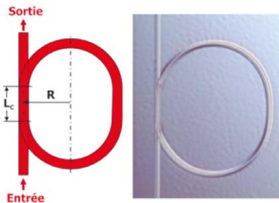
Parmi les capteurs optiques visant la détection d'espèces chimiques ou biologiques, les dispositifs basés sur des microrésonateurs présentent un intérêt spécifique: ils n'ont pas besoin de marqueurs fluorescents, et leur fabrication est peu coûteuse. Le présent article décrit un capteur de ce type, basé sur des guides en anneau immergés dans un circuit microfluidique, et donne une illustration de ses performances pour la détection d'ions lourds dans l'eau potable.
