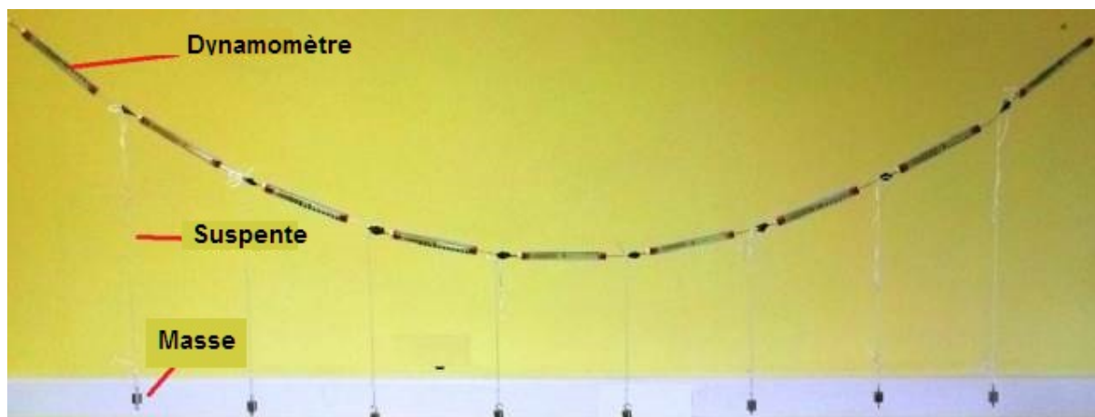
Fig. 3 : Une maquette d'un câble porteur.
