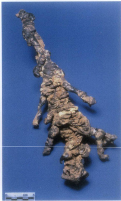
Figure 1. Exemples de scories de réduction dans la chaîne opératoire directe. a) Scorie coulée. b) Fond de four du Val Gabbia VI e siècle. © photos P. Fluzin.
