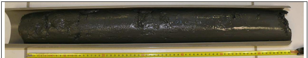
Figure 3-6 : Echantillon carotté déformé par allongement et aminci à ses extrémités faute de confinement axial au moyen de bouchons et d'un conteneur ajusté à la longueur du prélèvement. Argile molle et passages ou lits sableux. Diamètre de carottage 86 mm.
