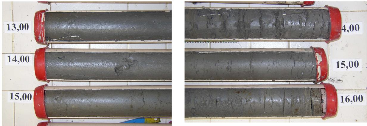
Figure 3-4 : Photos des extrémités de trois échantillons prélevés au carottier à piston stationnaire. Diamètres 76 mm. Sables limoneux, limons argileux, lits sableux. Sur la photo de droite, les pieds des échantillons montrent la présence de nombreuses fissures d'extension.
