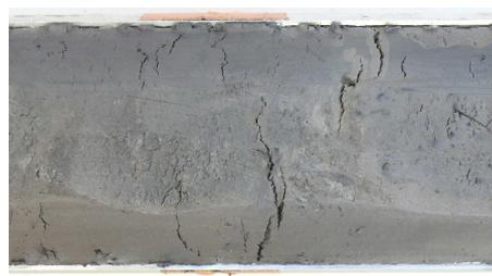
Figure 3-3 : Tronçons d'échantillons découpés par des fissures d'extension ouvertes. Diamètres 76 mm. Limons argileux et limons sableux.
