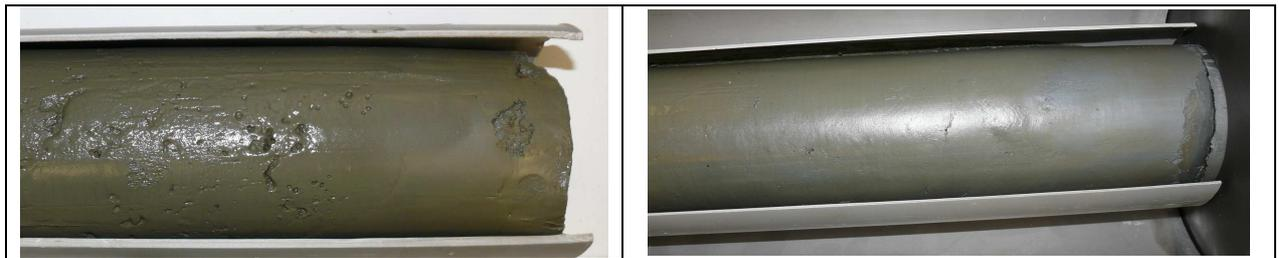
Figure 3-5 : Echantillons carottés déformés. Amincissement en pied par extension.
