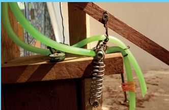
Un clapet en forme de «boulon»/ « vis-sans-fin boulonnée » sur ressort à actionner avec les poignets par un levier ou une pédale en bois. A valve in the form of a spring-loaded "button"/"bolted endless screw" to be activated with the wrists pushing against a lever or with a wooden pedal.
