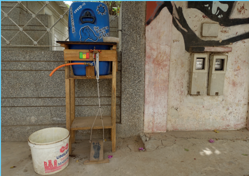
Kit en bois de récup «DIY» pour des réservoirs « famille » de 20 à 30 litres. DIY kit in salvaged wood for the 20 to 30 litre "family" of water tanks.
