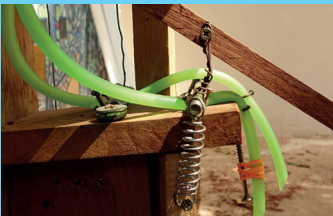
Un clapet en forme de « bouton »/ « vis-sans-fin boulonnée » sur ressort à actionner avec les poignets par un levier ou une pédale en bois. A valve in the form of a spring-loaded "button"/"bolted endless screw" to be activated with the wrists pushing against a lever or with a wooden pedal.
