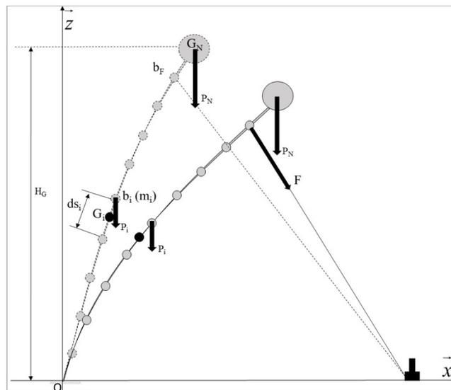
Fig. 2 : Discrétisation du problème.  $G_N$  est la position du centre de masse du houppier situé à la hauteur  $H_G$ ,  $b_F$  est le point d'application de la force,  $m_i$  est la masse au nœud  $b_i$ ,  $ds_i$  est la longueur de l'élément de centre  $G_i$  situé entre les nœuds  $b_i$  et  $b_{i-1}$
