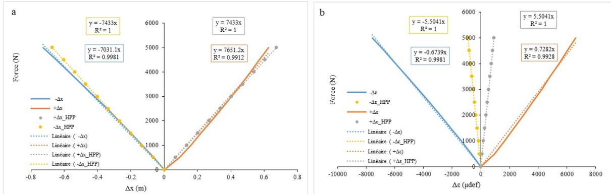
Fig. 4 : Comparaison des courbes force-déplacement et force-déformation issues du calcul en grand déplacement et du calcul RdM classique (HPP).  $\Delta x$  est la variation du déplacement du point d'application de l'effort et  $\Delta \epsilon$  est la variation de la déformation à 1.30 m.
