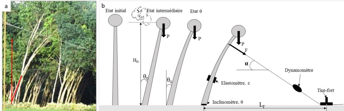
Fig. 1 : (a) Forme d'hévéas en plantation. (b) Processus d'inclinaison de l'arbre avant essai de flexion :  $\theta_0$  est l'inclinaison initiale de la base de l'arbre, la mesure de l'inclinaison  $\theta$  permettant de tenir compte d'une éventuelle rotation du système en cours d'essai,  $\epsilon$  la déformation longitudinale du tronc mesurée par les élastomètres,  $\alpha$  l'angle du câble avec l'horizontale
