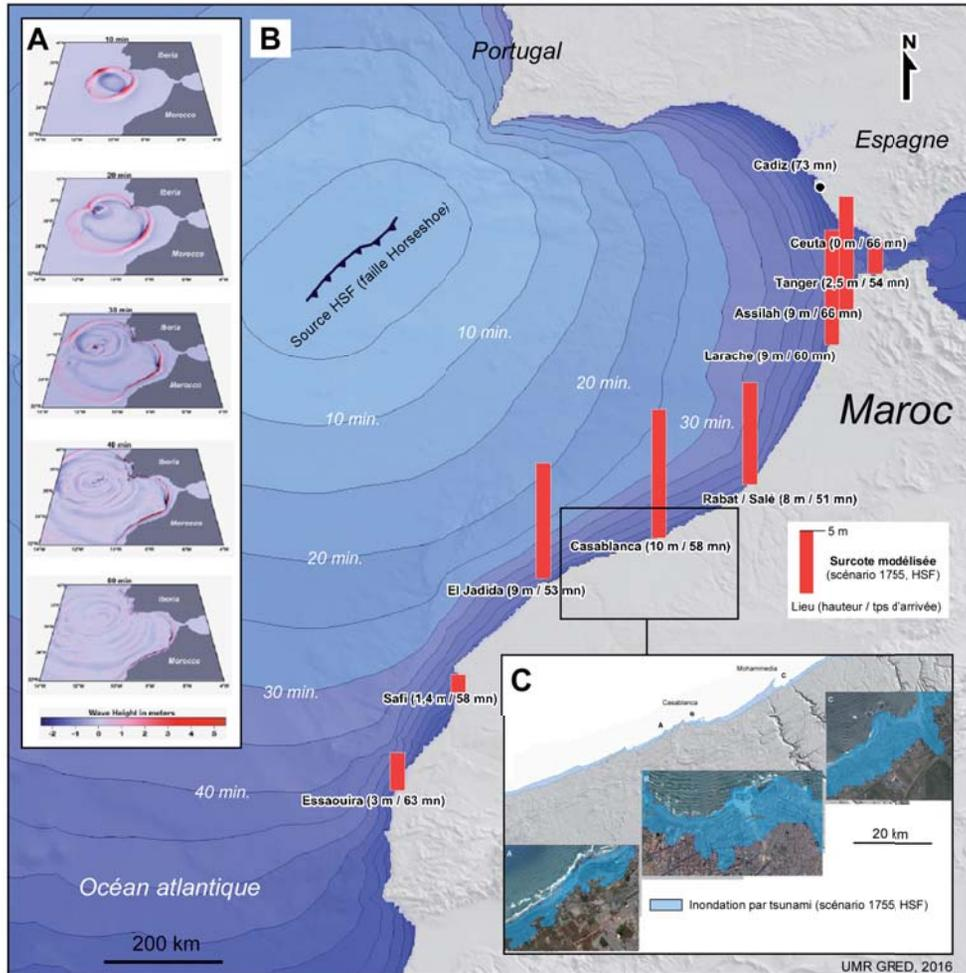
**Figure 2:** Modélisation numérique d’un tsunami proche de celui du 1<sup>er</sup> novembre 1755 (source HSF). A: propagation en haute mer, B: temps de trajets en minutes et hauteurs d’eau maximales à la côte, C: inondations associées sur quelques lieux.
