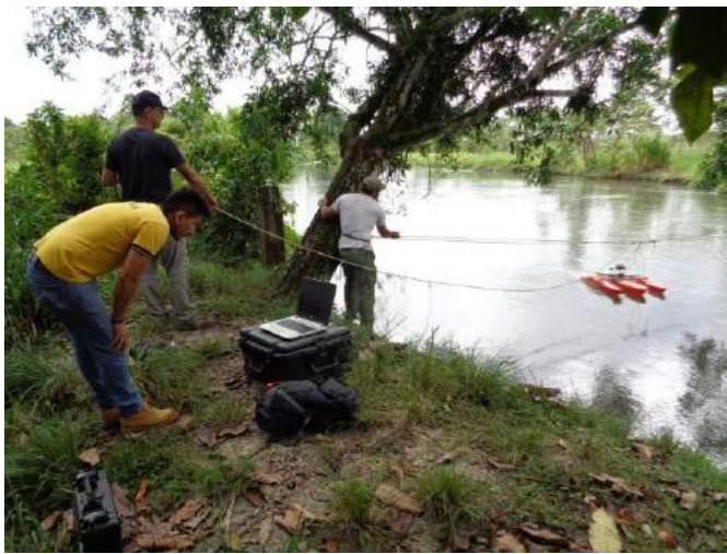
Figura 7 - Aforo del Río Negro con ADCP
