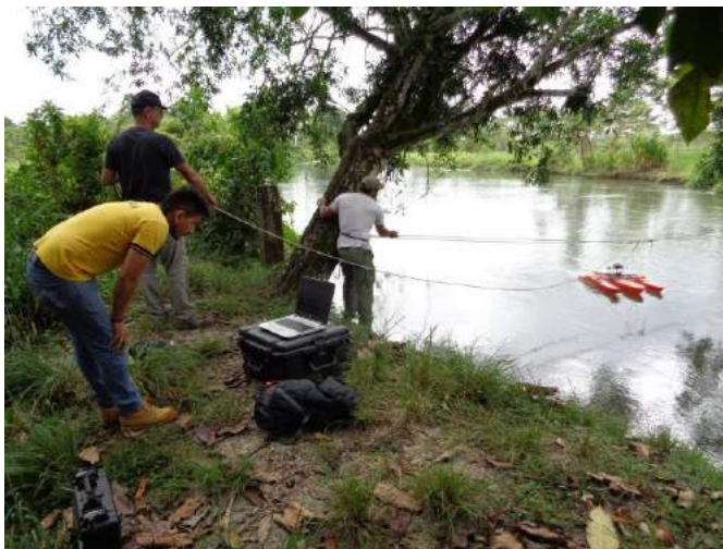
Figura 7 - Aforo del Río Negro con ADCP
