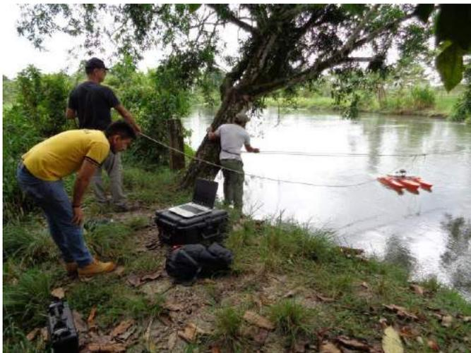
**Figura 7** - Aforo del Río Negro con ADCP
