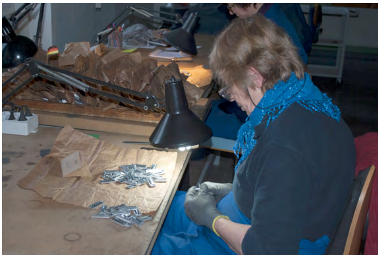
Fig. 1. Artisan ouvrier qui applique de la colle au soufflet dans l'atelier de montage de l'usine Galassi. Castelfidardo (Ancône), février 2015. Photo Raffaele Pinelli.
