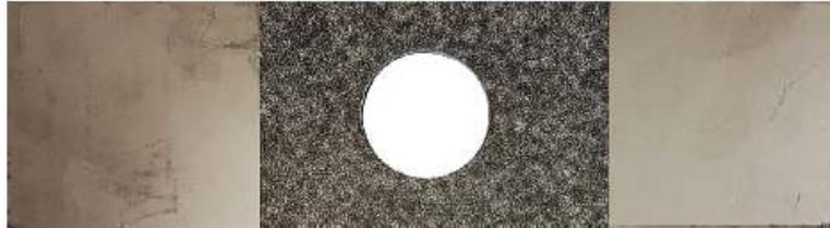
FIGURE 4 – Éprouvette en acier inoxydable 316L et son mouchetis.
