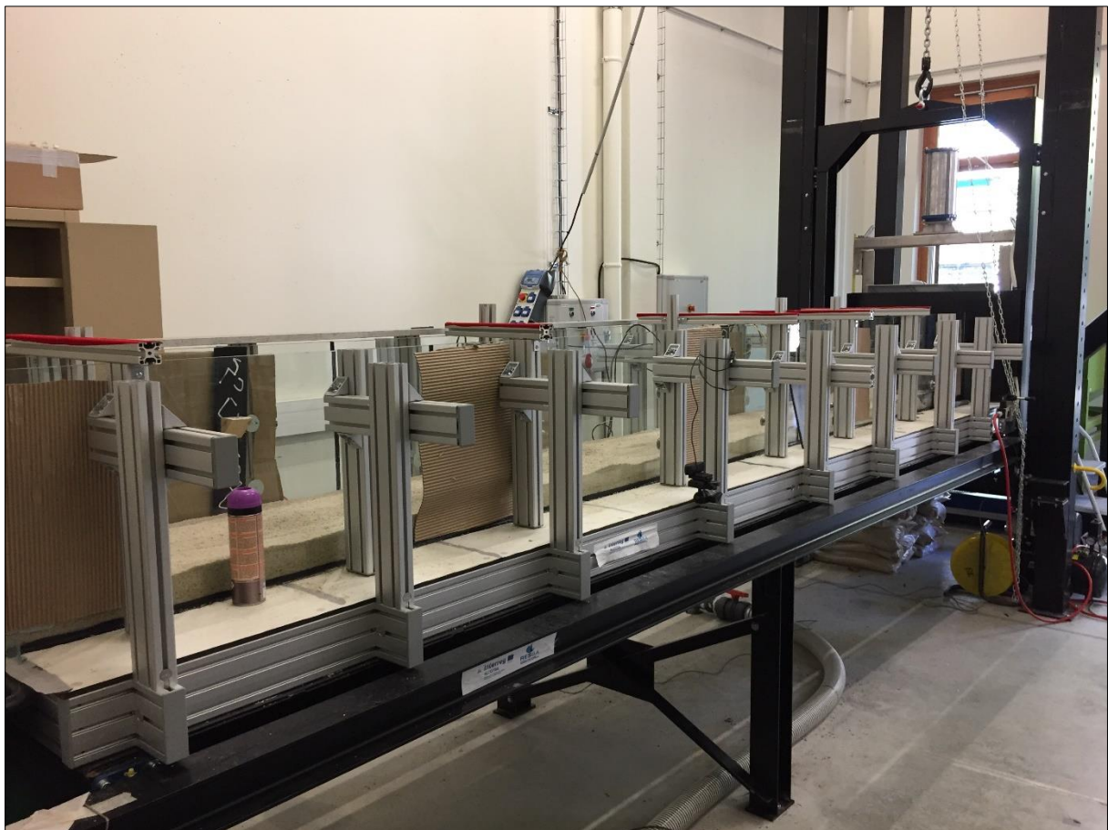
Figure 2: Photographie du canal expérimental (droite d l'image : amont du canal, gauche : aval)
