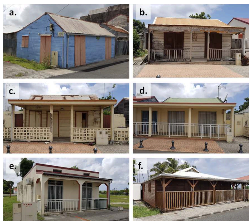
Illustration 6 - Typologie des habitations de plain-pied particulièrement vulnérables aux inondations et à la submersion marine
