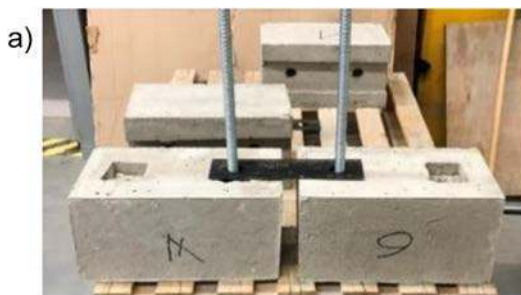
Fig. 2. Structure étudiée : blocs en béton liaisonnés par des barres verticales et des plaques horizontales (a) méthode d'assemblage entre deux blocs ; (b) mur avant impact.
