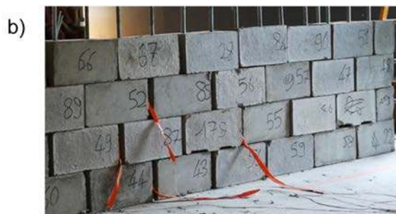
Fig. 2. Structure étudiée : blocs en béton liaisonnés par des barres verticales et des plaques horizontales (a) méthode d'assemblage entre deux blocs ; (b) mur avant impact.
