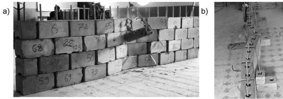
Fig. 3. Dispositif d'essais : impact sur (a) mur droit ; (b) mur avec murs de refend. Fig. 3. Test facility: impact on (a) straight wall; (b) wall with perpendicular partition walls.
