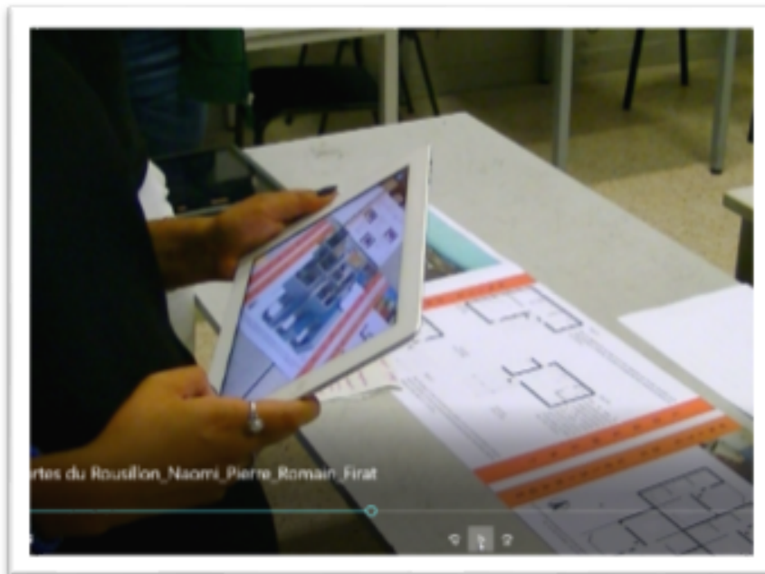
Fig. 8 : Visualisation des typologies spatiales en 3D à partir de plans grâce à la réalité augmentée. Le village de vacances « Les portes du Roussillon, Georges Candilis, Port-Barcarès, 1972
