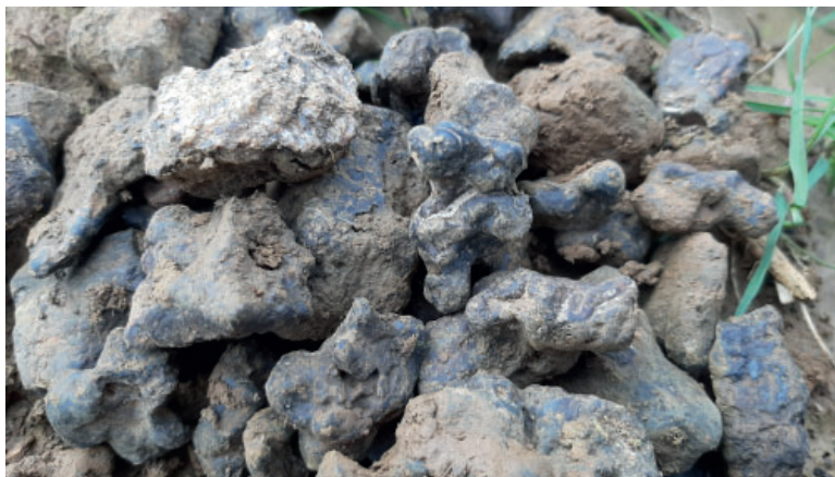
Figure n°24. Scories de réduction typiques de la Protohistoire : Lantenne-Vertière « Les Longues Raies » (district de Berthelange)
