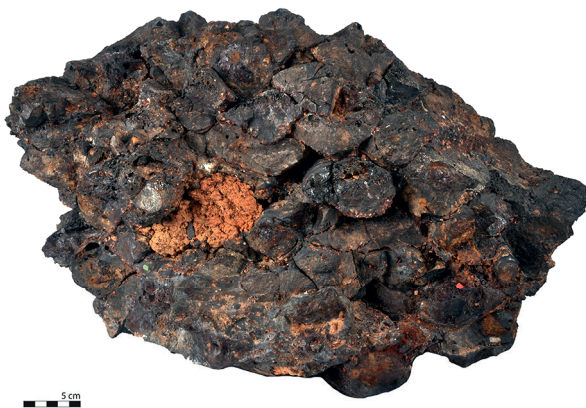
Type A5 : empilement d'écoulements en boudins canalisés
