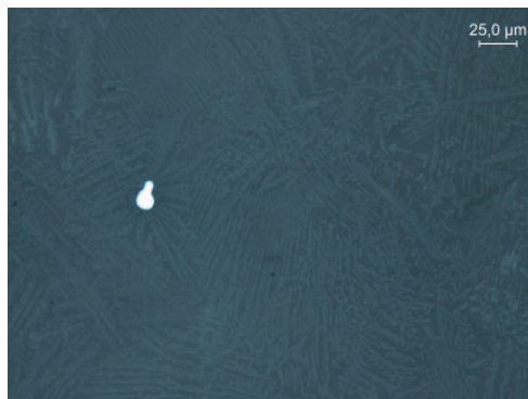
Matrice microcristallisée avec bille de fer
