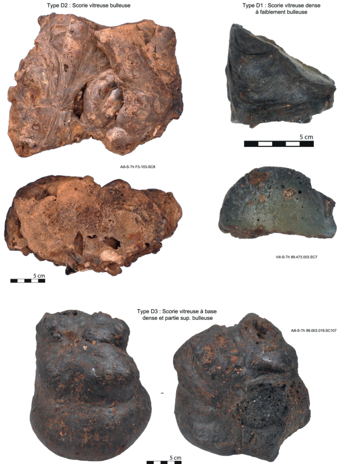
Figure n°87. Typologie des écoulements vitreux (type D)
