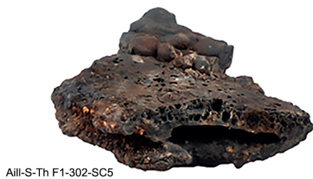
Type A3 : écoulements non cordés et grande cavité centrale
