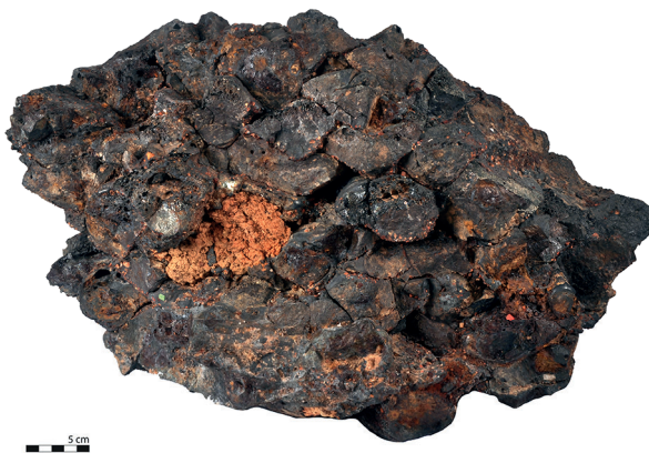
Type A5 : empilement d'écoulements en boudins canalisés
